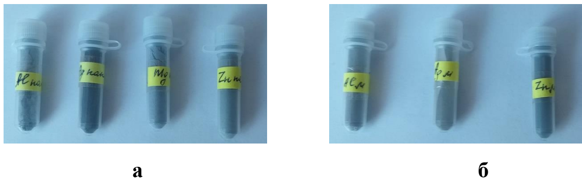
Рис. 1 Контейнери з металевими частинками нано- (а) та мікрочастинками (б) використаних металів
