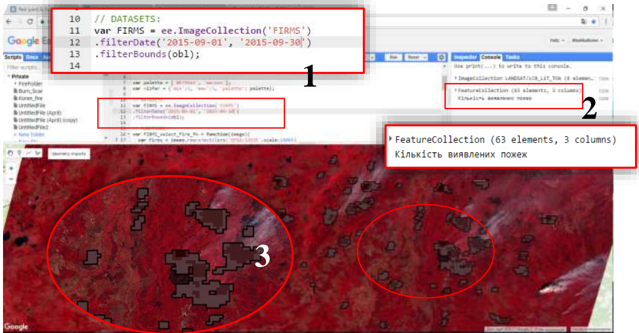
Рисунок 3.5 – Використання платформи GEE для дешифрування пожеж на території Рівненської області (вересень 2015 р.): 1 – вибір дати; 2 – кількість виявлених пожеж (63); 3 – орієнтовні контури пожеж
