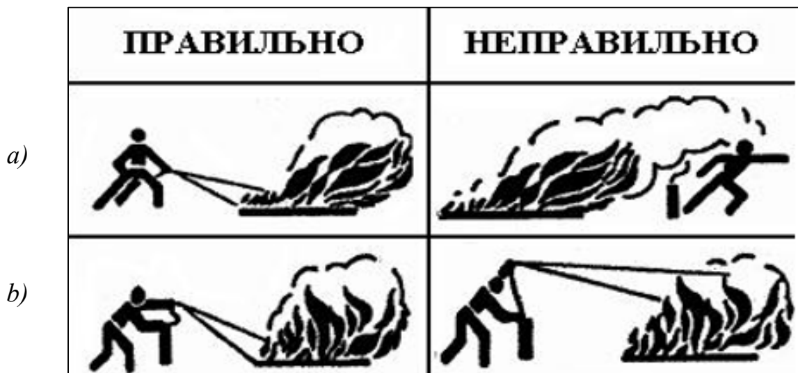
Використання вогнегасника: a) – з навітряної сторони; b) – у рівнинних умовах зі сторони фронту пожежі
