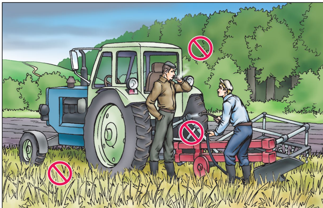
Ремонт сільськогосподарської техніки із порушенням правил пожежної безпеки
