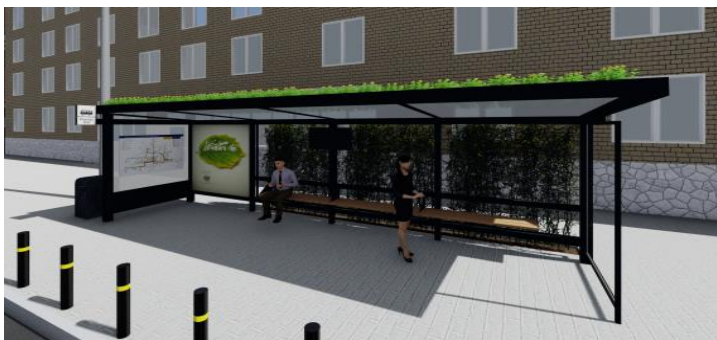
Рис. Проект зупинки «Готель Україна» із системою «седумний килим» на даху (розроблено автором)
