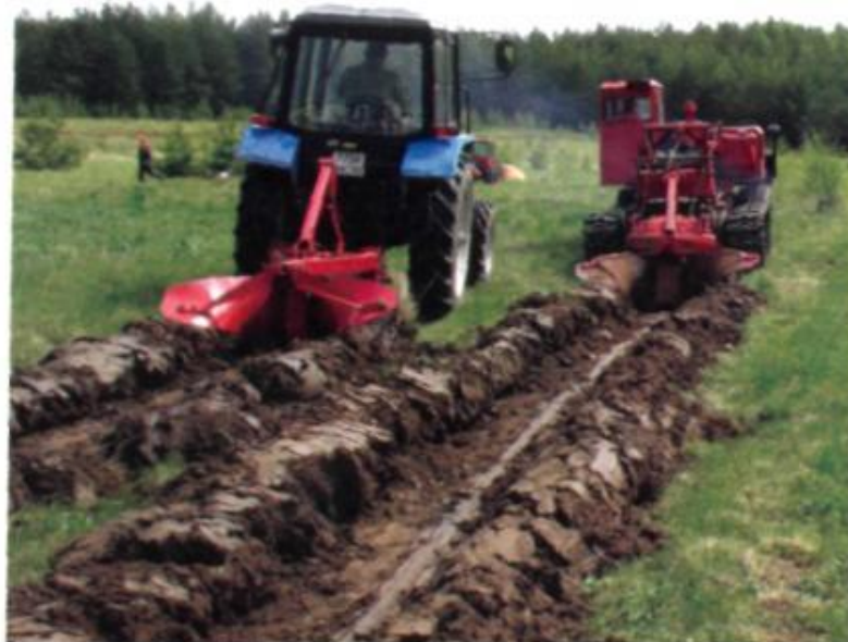
Рис. 7.1 - Лесопожарный фрезерный агрегат АЛФ-10
