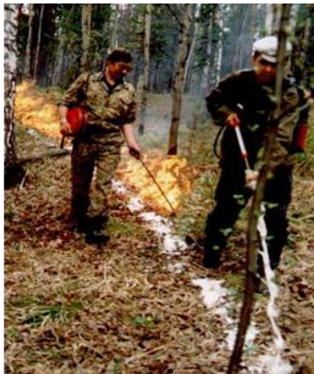
Рис. 7.10 – Зажигание лесного напочвенного покрова зажигательным аппаратом АЗ-1 при пуске отжига от опорной полосы, проложенной химическим составом
