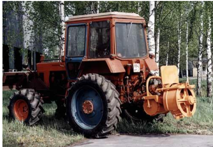
Рис. 7.1 - Лесопожарный фрезерный агрегат АЛФ-10
