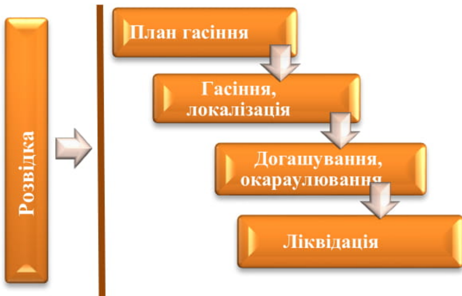
Рис. 2. Стадії гасіння лісових пожеж
