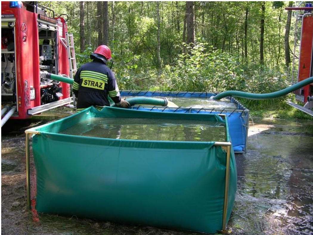
Рис. 25. Приклад використання мобільних резервуарів для води під час реагування на лісову пожежу (фото із сайту – http://surl.li/zhqm )
