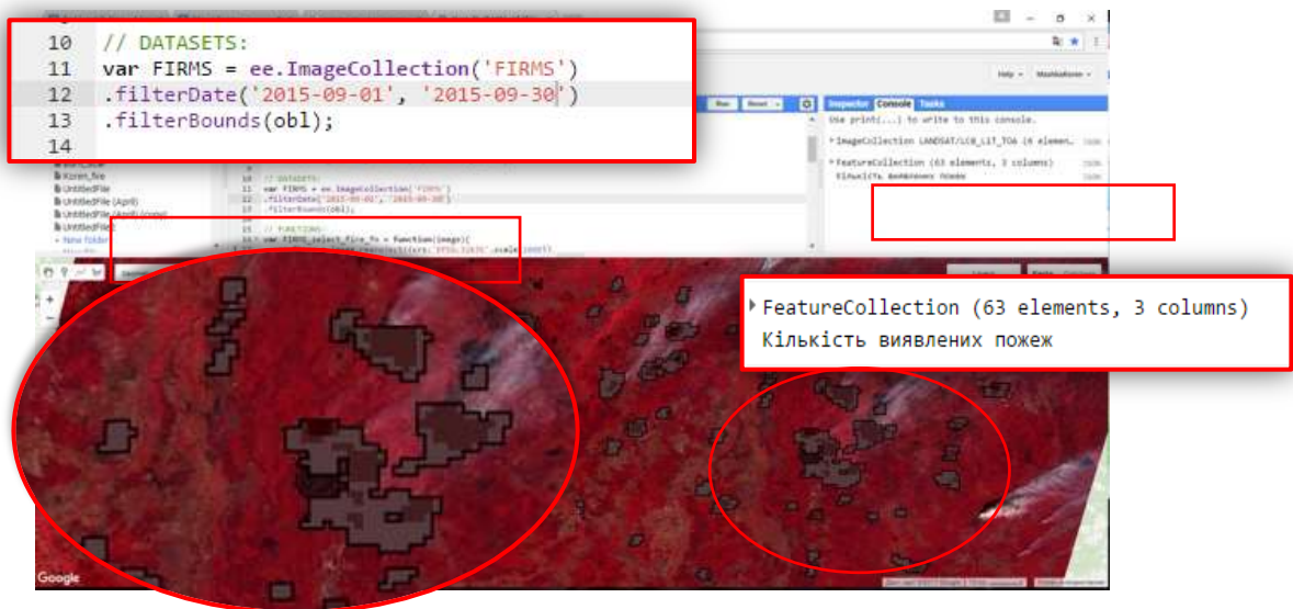
Рис. 1.3. Використання платформи GEE для дешифрування пожеж на території: 1 – вибір дати; 2 – кількість виявлених пожеж (63); 3 – орієнтовні контури пожеж
