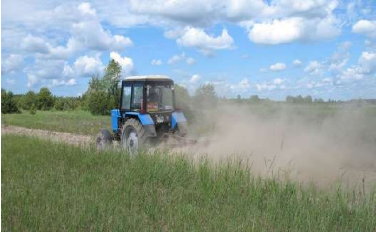
Рис. 2.55. Під час прокладання мінералізованих смуг утворюється радіоактивний пил, що може призвести до збільшення інгаляційних доз водія трактору (Фото: В. Йощенко)
