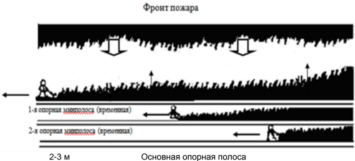
Рис. 7.8 – Отжиг «ступенчатым огнем»
