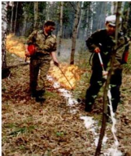
Рис. 7.10 – Зажигание лесного напочвенного покрова зажигательным аппаратом АЗ-1 при пуске отжига от опорной полосы, проложенной химическим составом
