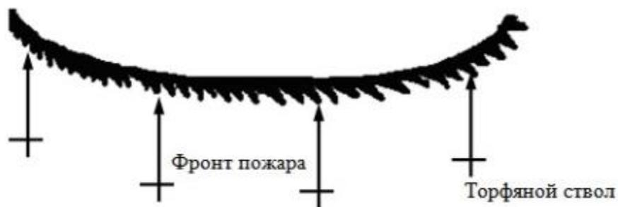
Рис. 7.11 – Схема локализации очага горения торфяного пожара
