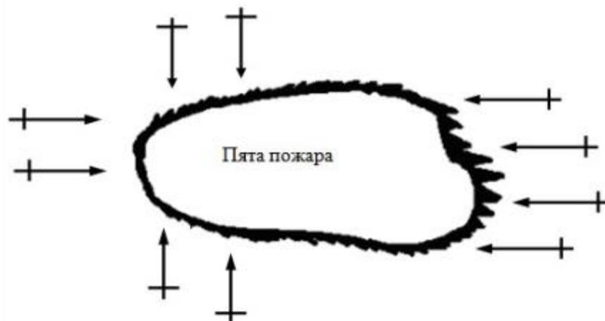
Рис. 7.14 – Схема ликвидации очага горения торфяного пожара со сформировавшимися его тактическими элементами
