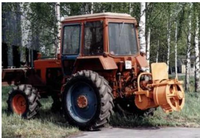
Рис. 7.1 - Лесопожарный фрезерный агрегат АЛФ-10
