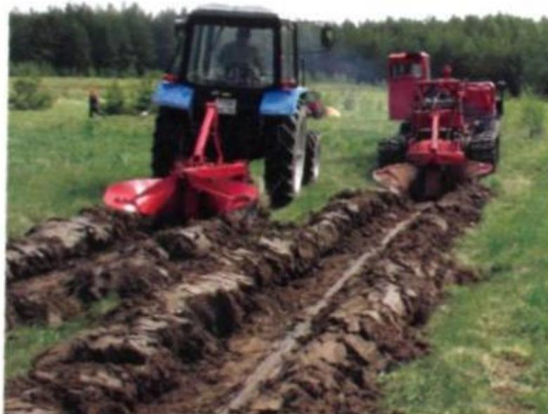
Рис. 7.2. – Прокладка минерализованных полос плугами ПКЛ-70 (слева) и ПЛШ-0,4 (справа)
