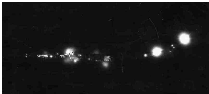
Рис. 10.6. Радиоавтографи звичайних радіоактивних частинок і гарячих частинок чорнобильського походження на хвої сосни (А.А. Булах, 1986).
