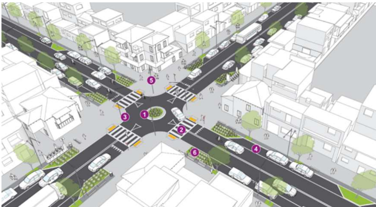
Рис. 1. Приклад особливостей облаштування зони низької швидкості на житловій вулиці з невисокою інтенсивністю руху: 1. Перехрестя з круговим рухом; 2. Пішохідний перехід; 3. Розширений тротуар; 4. Місця для паркування; 5. Освітлення; 6. Ландшафтний дизайн (зони озеленення)
