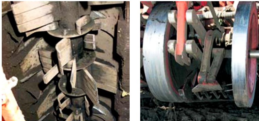
Рис. 1. Робочі органи комбайна Maxtron 620: а – робочі органи для відокремлення гички; б – котки для вдавлювання подрібненої гички в ґрунт.
