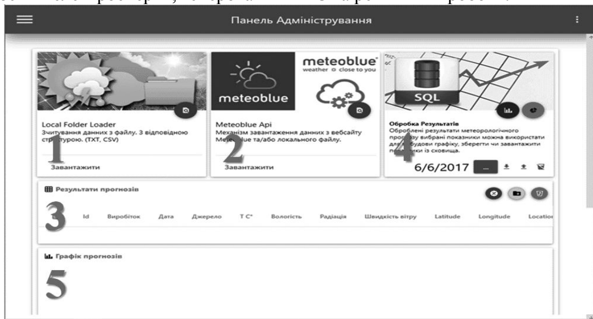
Рис. 1. Інтерфейс програмного додатку прогнозування виробітку електроенергії на ФЕС.
