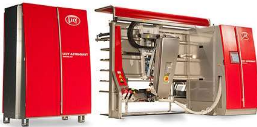
Рисунок 1 – Роботизована система для доїння корів Lely Astronaut A 4
