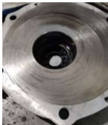
Зношені поверхні тертя вакуумного насоса
