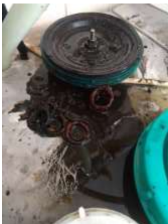
Вихід з ладу клапана подачі води
