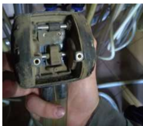
Потрапляння пилу та бруду до пульсаторів
