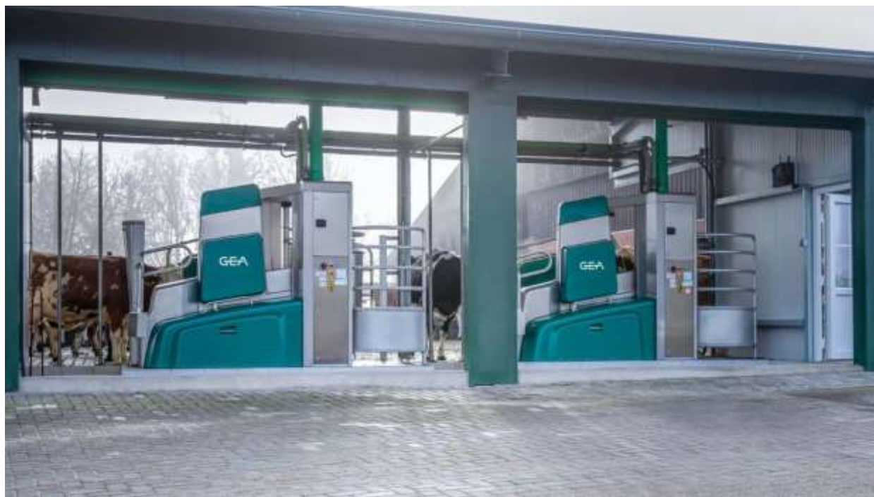
Рисунок 5 – Роботизована система для доїння корів DairyRobot R9500 Robotic Milking System
