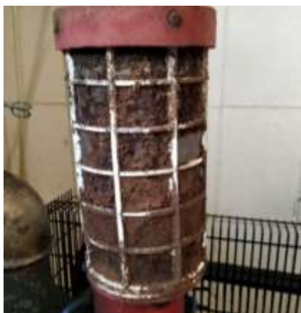
Фільтр пастка ресивера вакуумного насоса
