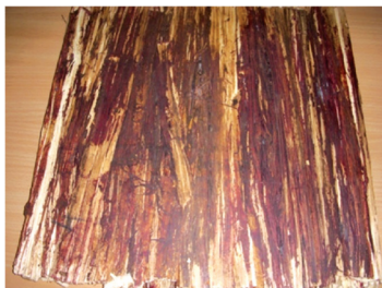
Тришаровий деревинно-композиційний матеріал на основі розчавлення гілок тополі з перпендикулярним розташуванням волокон.
