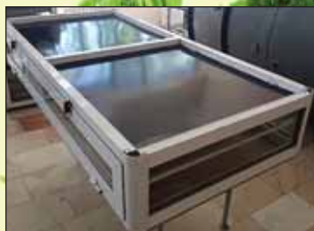
Рис.1. Гелио сушильная установка с аккумуляцией солнечной энергии
