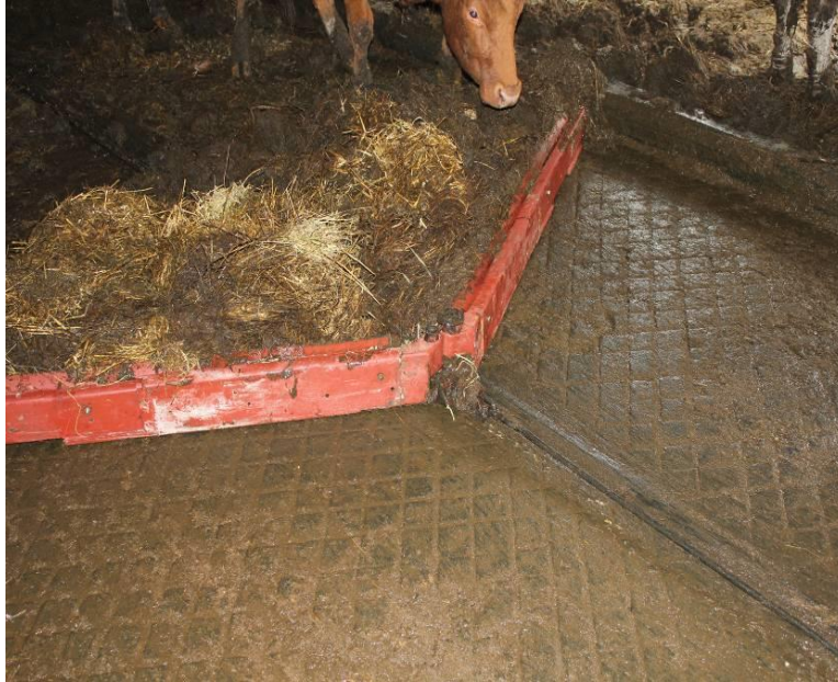
Рис. 2. Скреперна установка в роботі.
