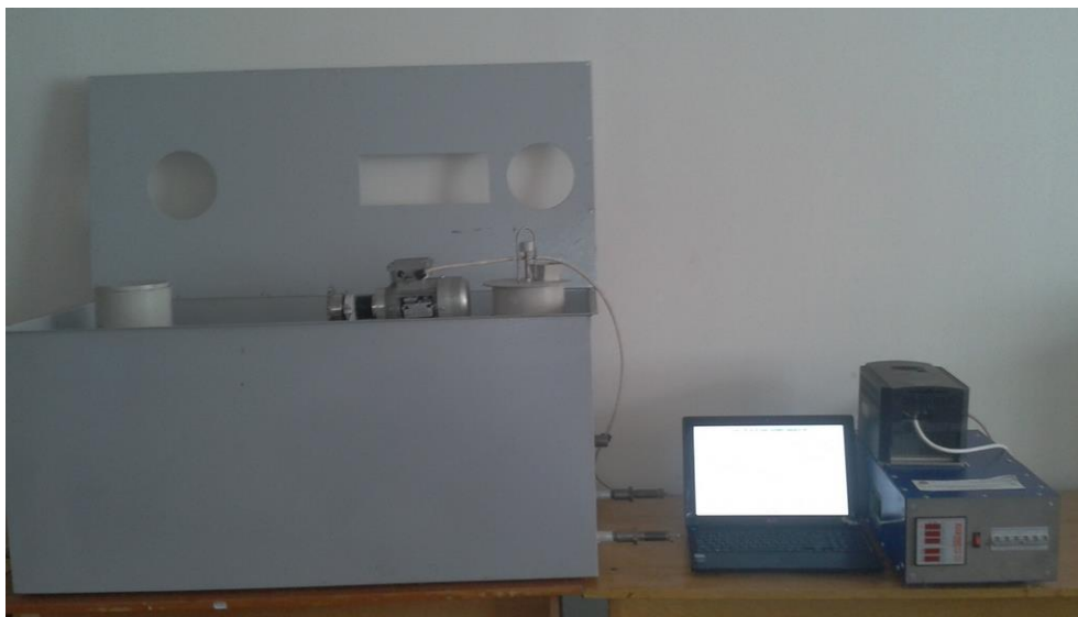
Рис. 2. Обертовий метантенк встановлено у зовнішній корпус.
