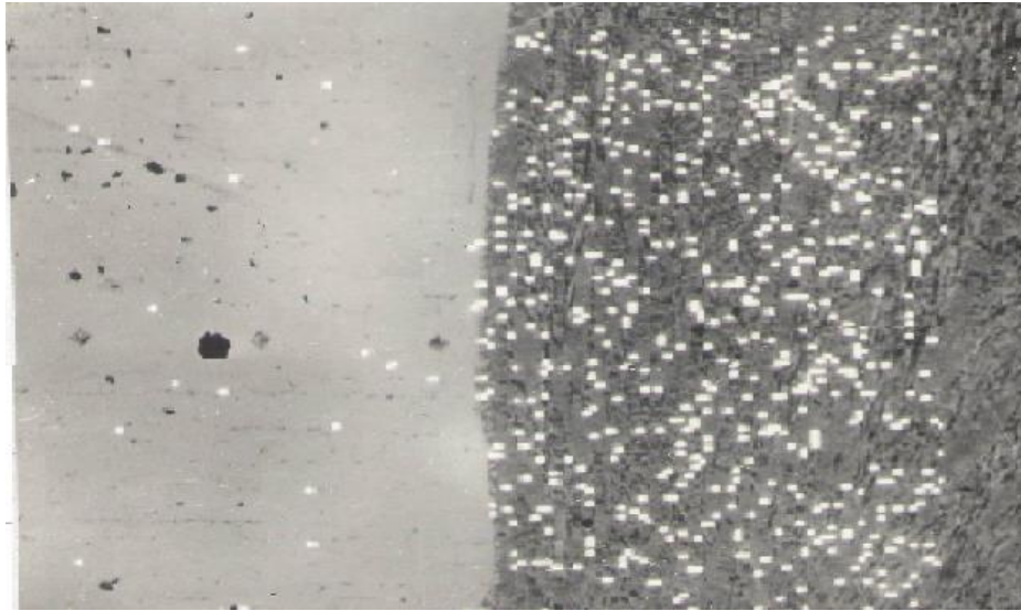
Рис. 5. Глибина проникнення хрому (дифузійна зона) в основу молотка, \times 1000 .
