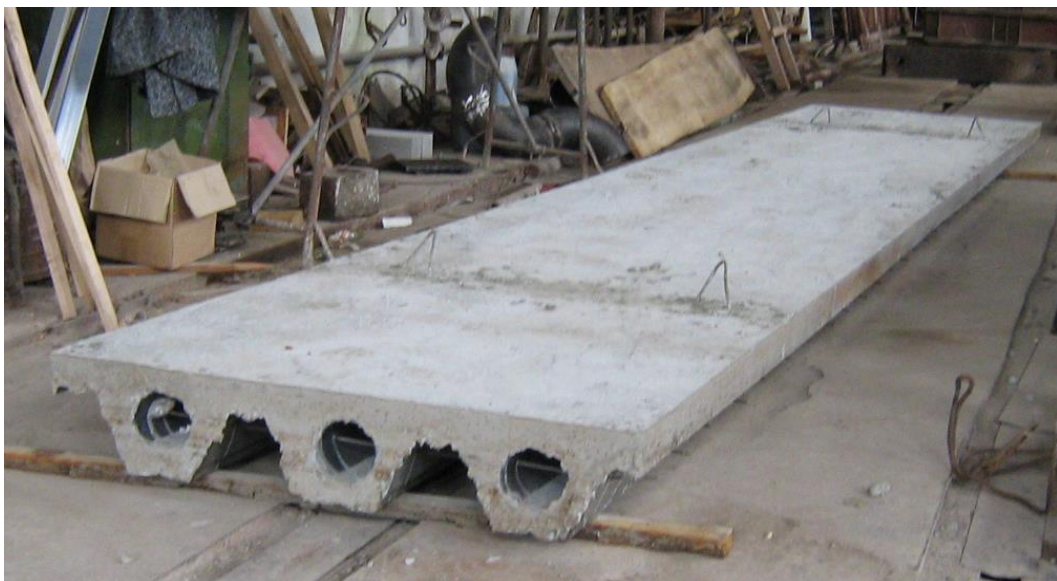
Рис. 4. Порожнисторебриста плита розміром 1000х6000 мм після виготовлення і розпалубки.
