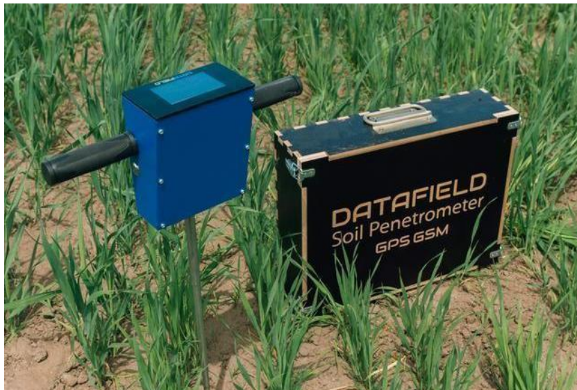
Рис. 2 – Ручний пенетрометр з електронним циферблатом та GPS
