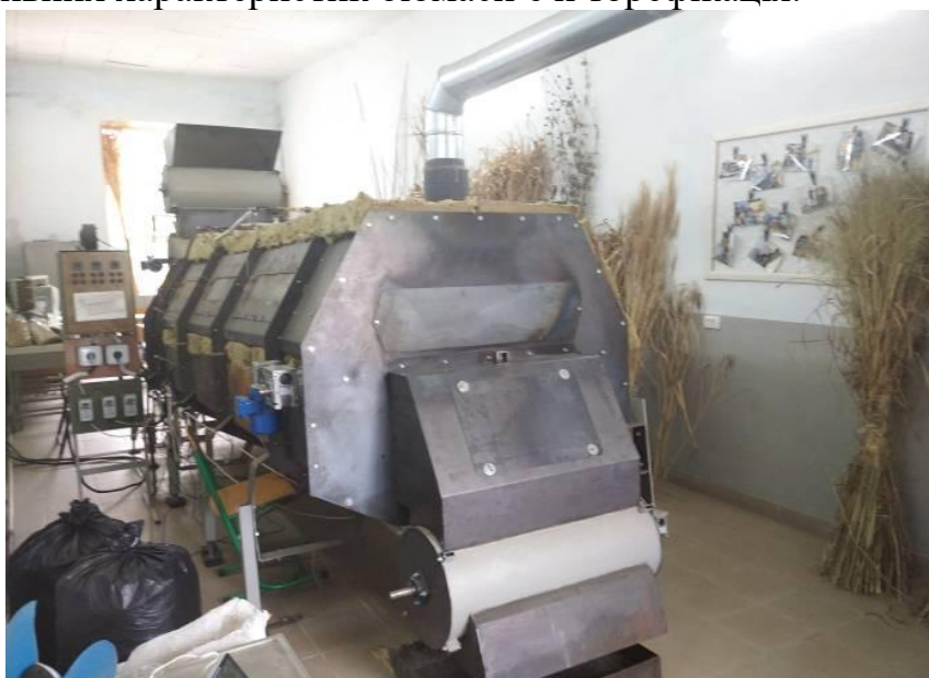
Рис.1. – Дослідна установка для торефікації, навчально-наукової лабораторії «DAK GPS» закладу вищої освіти «Подільський державний університет»
