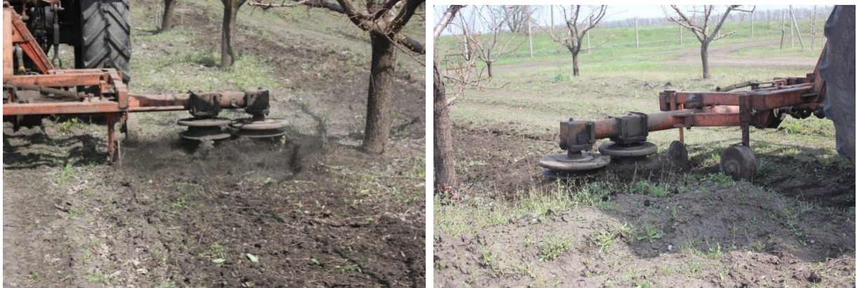
Рис. 3. Обробіток ґрунту в пристовбурній смузі фрезерною машиною МФ-1М з експериментальними робочими органами
