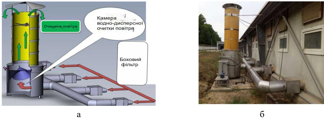
Рис. 2. Схема пристрою для очищення повітря та його практичне втілення на виробництві
