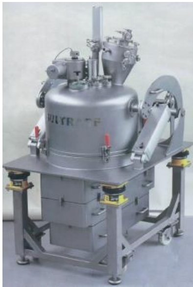
Рис. 1.13. Сушильна фармацевтична центрифуга CDR (а) та її принципова схема (б)
