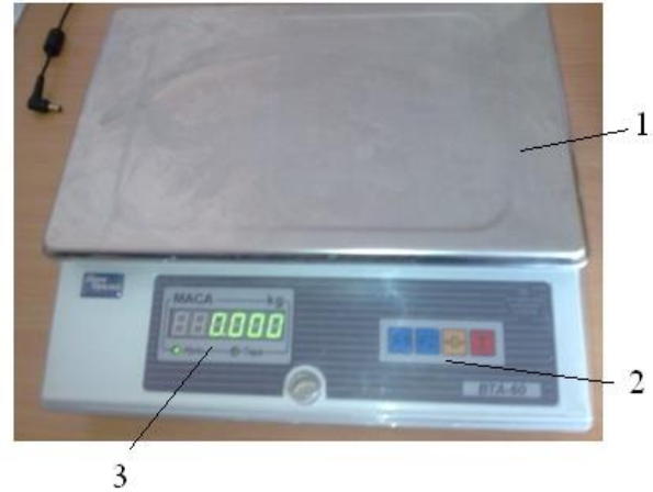
Рис. 2.6. Електронні лабораторні технічні ваги ВТА-60: 1 - звішувальне деко; 2 - панель калібрування; 3 - індикаторний дисплей
