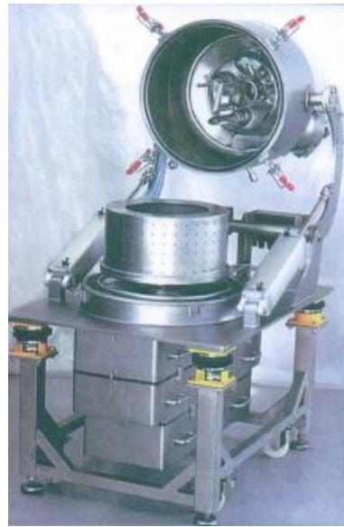
Рис. 1.13. Сушильна фармацевтична центрифуга CDR (а) та її принципова схема (б)
