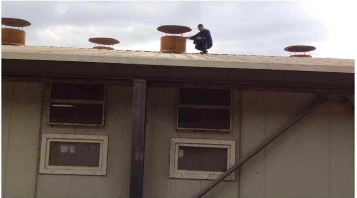
Рис. 3.6. Заміри рівня концентрації газів на виході з верхньої камери очистки повітря (фото автора)
