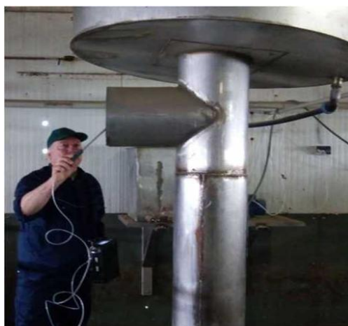
Рис. 3.4. Заміри рівня концентрації газів на вході в боковій точці верхньої камери очистки повітря (фото автора)
