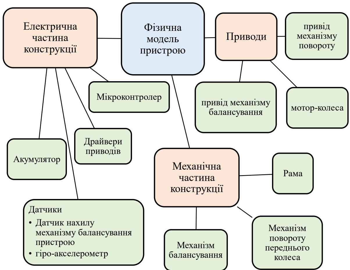
Рисунок 2.2 – Структура конструкції пристрою
