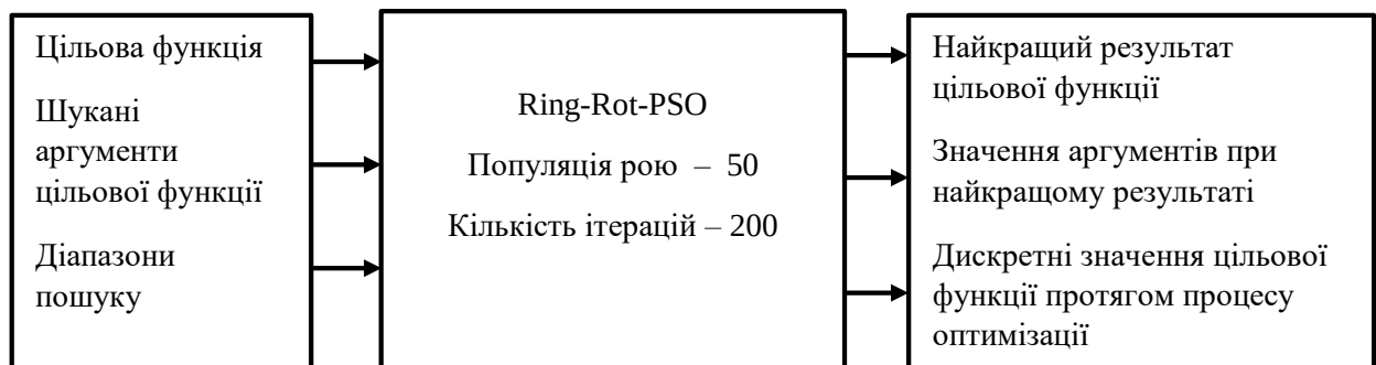
Рисунок 3.7 – Умовне зображення роботи алгоритму Ring-Rot-PSO
