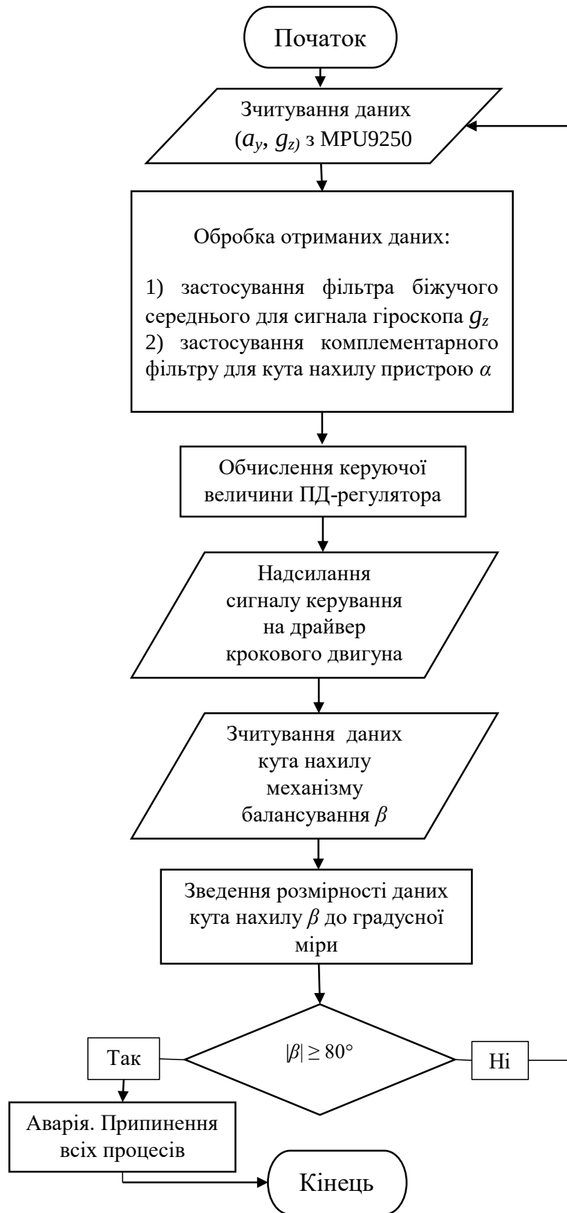
Рисунок 2.13 – Алгоритм роботи пристрою в режимі стабілізації положення
