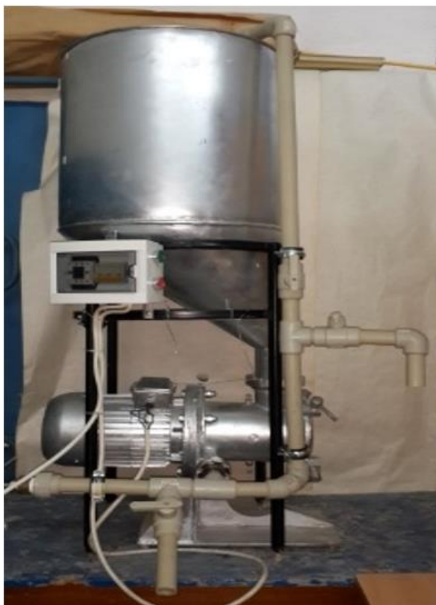
Рис. 4.1. Роторно-пульсаційна установка для приготування рідких зернових кормів
