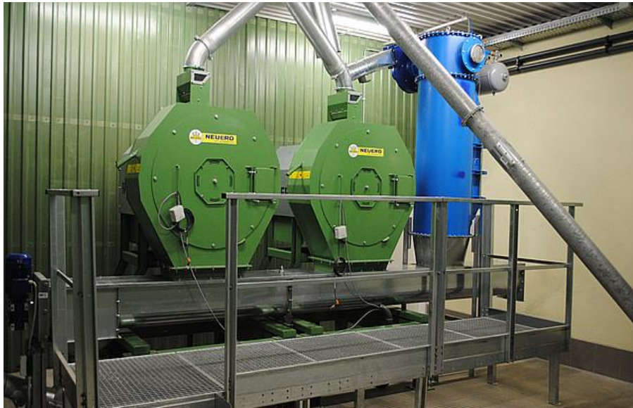
Рис. 1.15. Молоткова дробарка серії RVO німецької компанії «Neuhof» [29]
