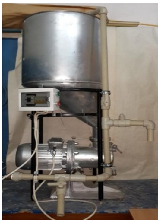
Рис. 5.1. Роторно-пульсаційна установка для приготування рідких зернових кормів
