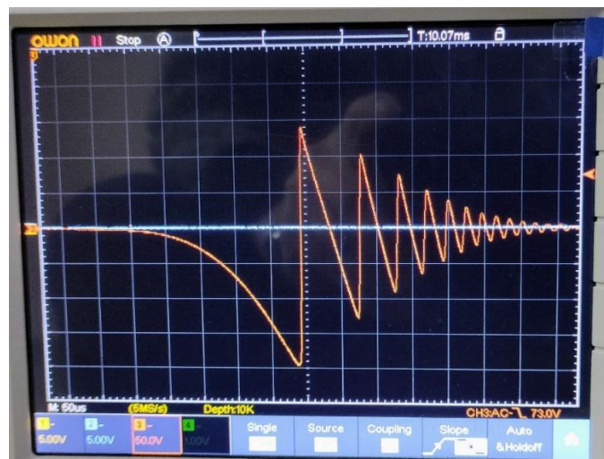
Рис. 4.12. Осцилограма струмів при пуску двигуна РПА(а – загальний вид, б – фаза С в розширеному вигляді)
