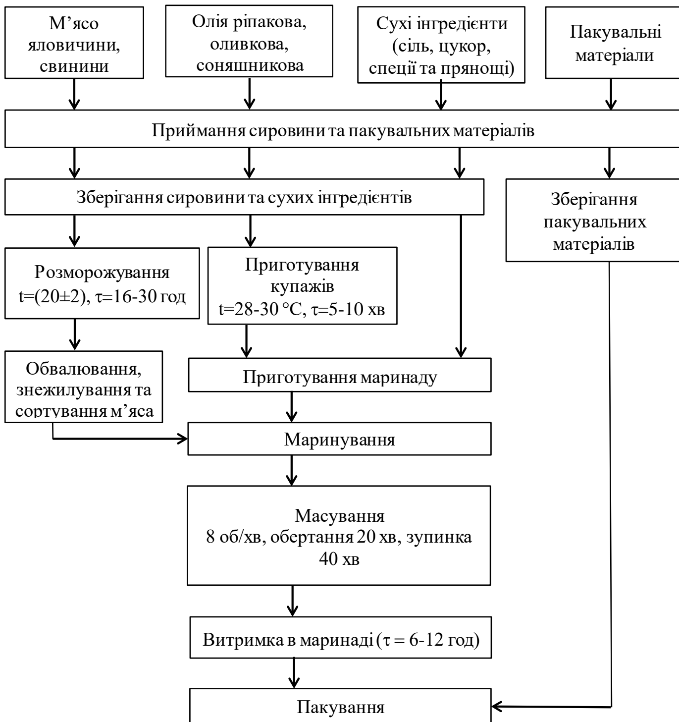
Рис. 3.15. Удосконалена технологічна схема виробництва натуральних м'ясних маринуваних напівфабрикатів
