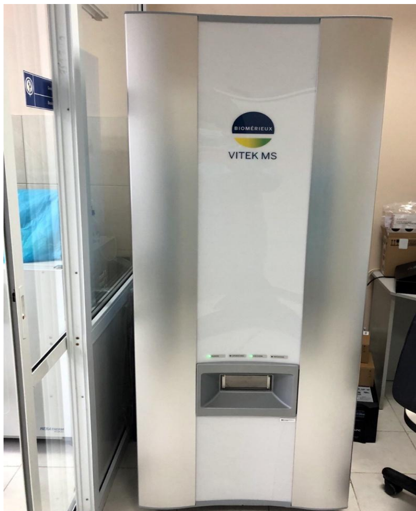
Рис. 2.4. Прилад для ідентифікації мікроорганізмів VITEK MS.
