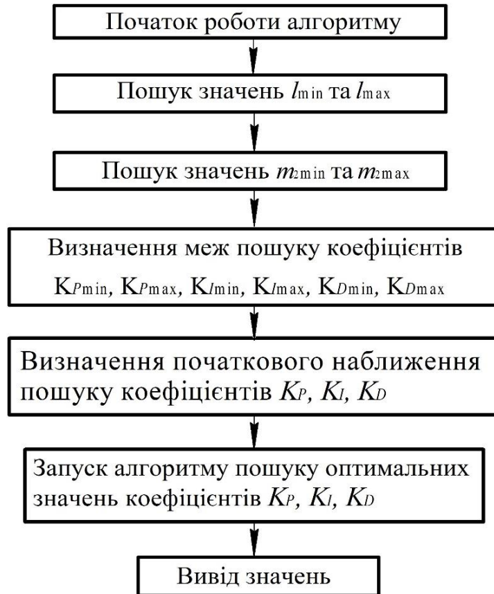
Рисунок 2.2 – Блок-схема пошуку коефіцієнтів ПІД-регулятора
