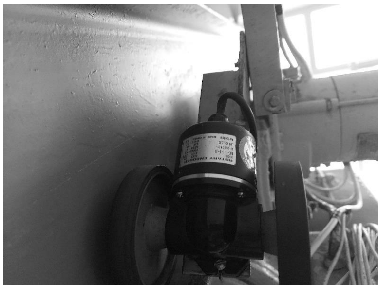
Рисунок 4.6 – Енкодер з мірним колесом Autonics ENC-1-1-t-24, закріплений на корпусі візка (колесо датчика прижато до полиці двотавра по якому рухається візок)
