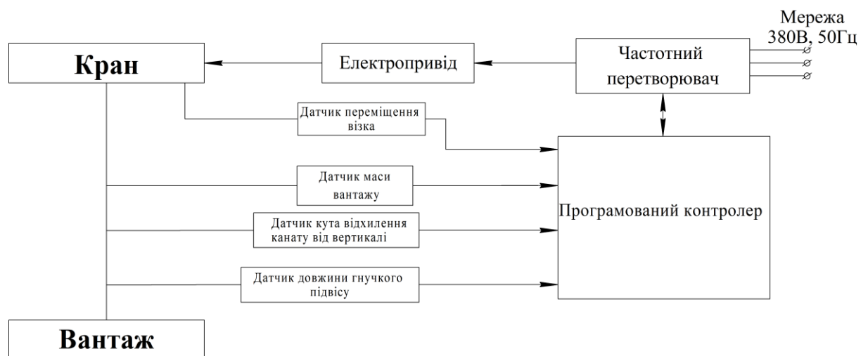
Рисунок 6.4 – Загальний вигляд структурної схеми керування рухом крана з вантажем на гнучкому підвісі
