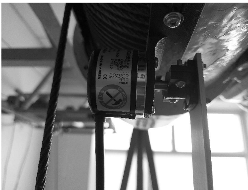
Рисунок 4.7 – Інкрементальний енкодер Autonic E40S6-5000-3-T-24 для вимірювань кута відхилення канату від вертикалі (вал енкодера з'єднаний із гілками каната)
