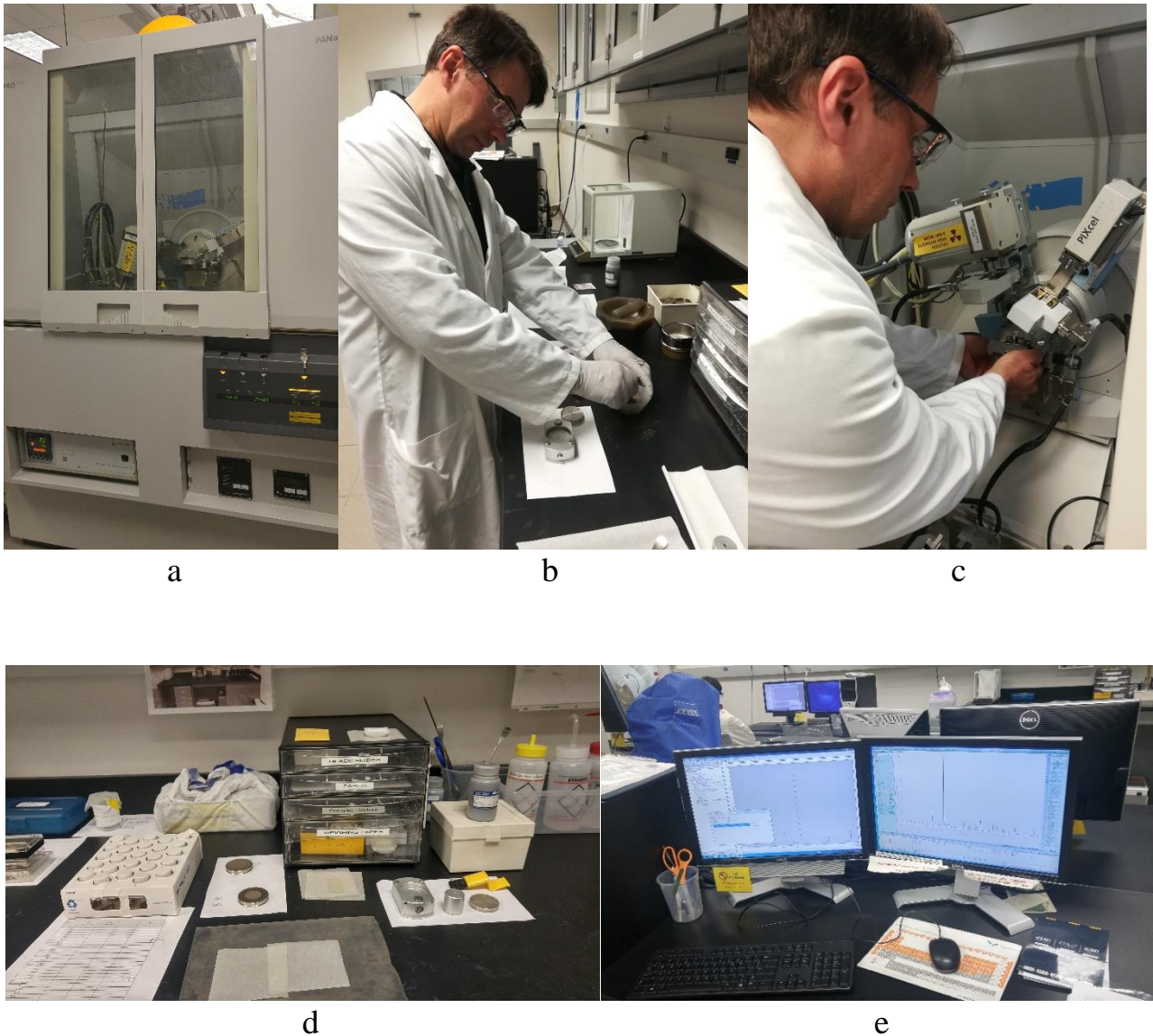
Б 32. Визначення мінералогічного складу ґрунту на рентгеновському дифрактометрі PANalytical XPERT-PRO MPD: а – загальний вигляд приладу; б – підготовка ґрунтової проби до аналізу; с – інсталяція ґрунтової проби з фіксатором у одиничний пробовідбірник; д – робочий стіл із пробами ґрунту, станком для формування проби та Ni порошком; е – поточний графічний запис сканування програмою Data Collector vs. 4.4a
