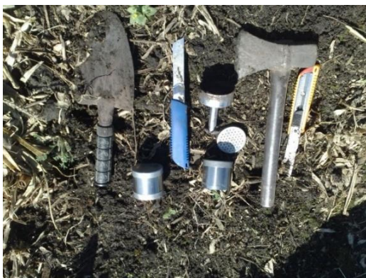
Б 14. Відбір керових проб ґрунту для визначення щільності складення
