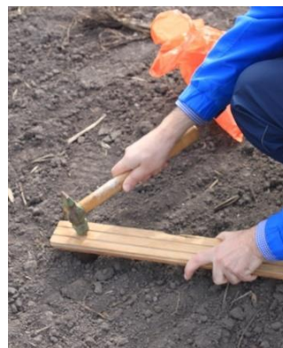
Б 14. Відбір керових проб ґрунту для визначення щільності складення
