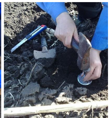
Б 14. Відбір керових проб ґрунту для визначення щільності складення
