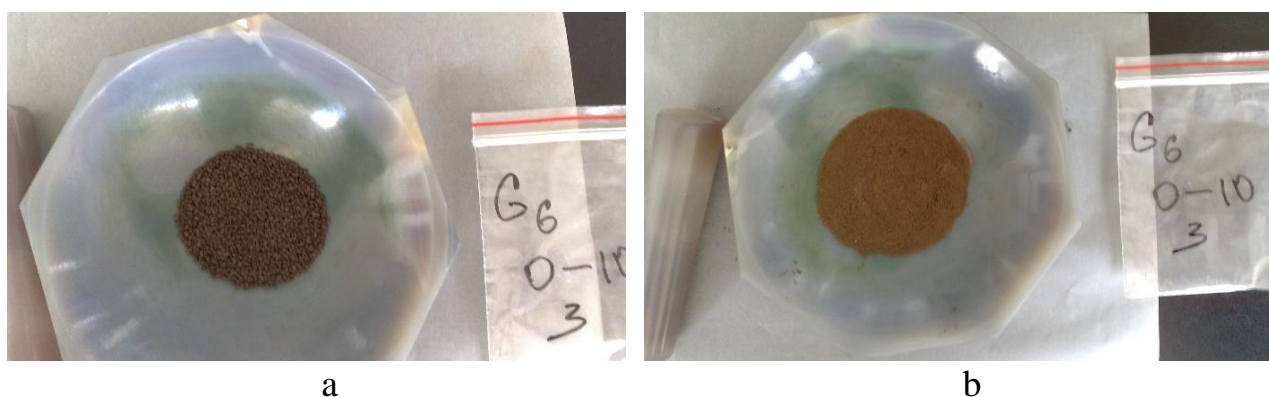
Рис. 5.6. Зовнішній вигляд 2-1 мм фракції водостійких агрегатів ізогумусолу до (a) і після (b) розтирання в агатовій ступці
