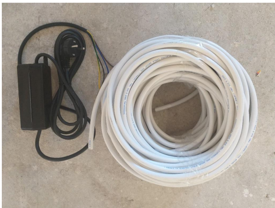
Рис. Б.12. Кабель живлення та конденсаторна коробка статора БЦПЭ 0,5-40У
