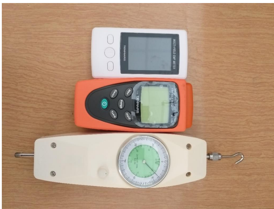
Рис. Б.1. Вимірювальні пристрої НК-300, Tenmars TM-191 Magnetic Field Meter, Tenmars TM-190 Multi Field EMF Meter
