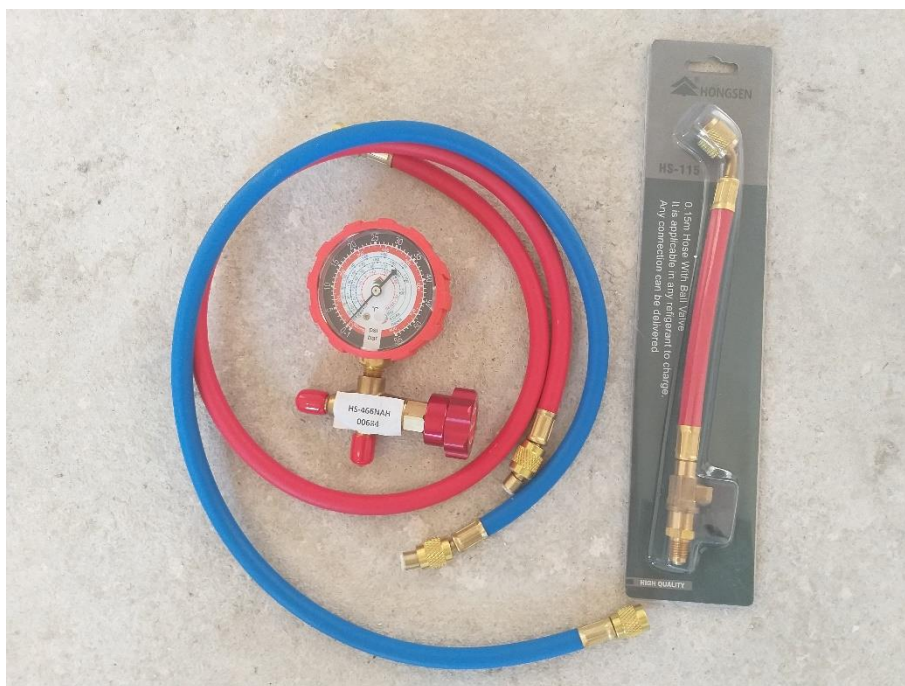
Рис. Б.10. Шланг заправний HS-115 R-134 HongSen, колектор 1 вентильний HS-466NAH, шланг універсальний для заправки фреону, кран Універсал СТ-339
