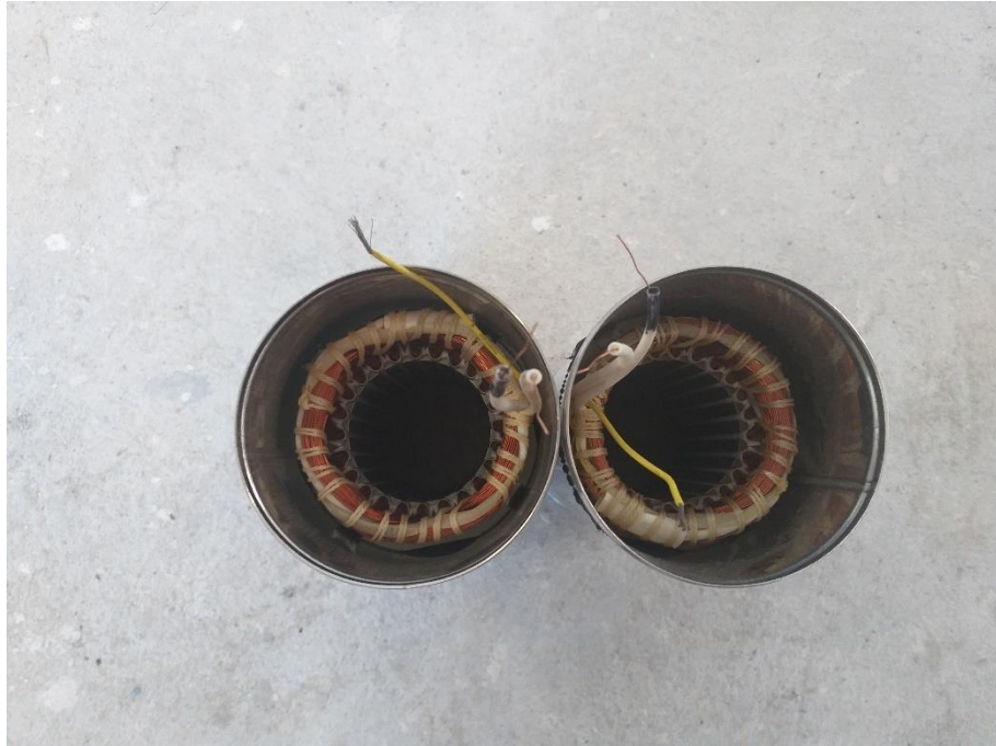
Рис. 4.21. Однофазні статори БЦПЕ 0,5-40У, 720 Вт
