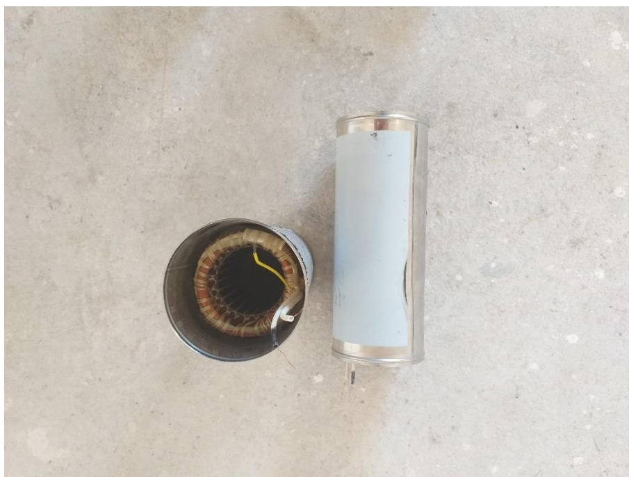
Рис. Б.3. Статор в корпусі (обмотка двигуна) для насосу Водолій БЦПЭ 0,5-40
