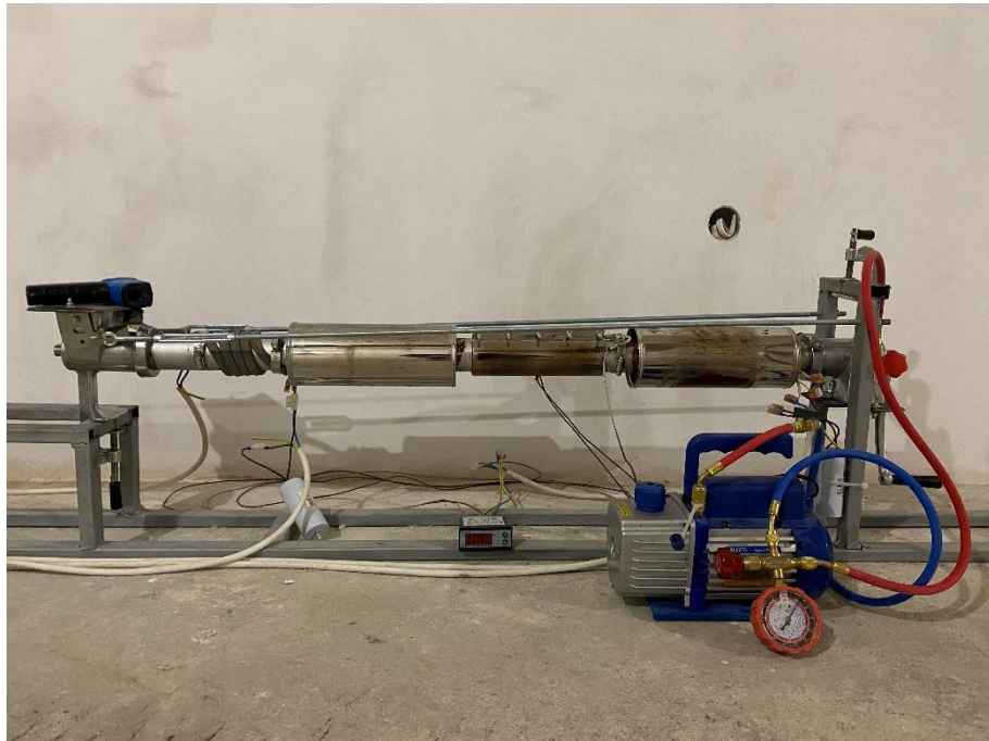
Рис. 4.18. Макетний зразок шнекового електромеханічного гідролізера з приладами вимірювання параметрів
