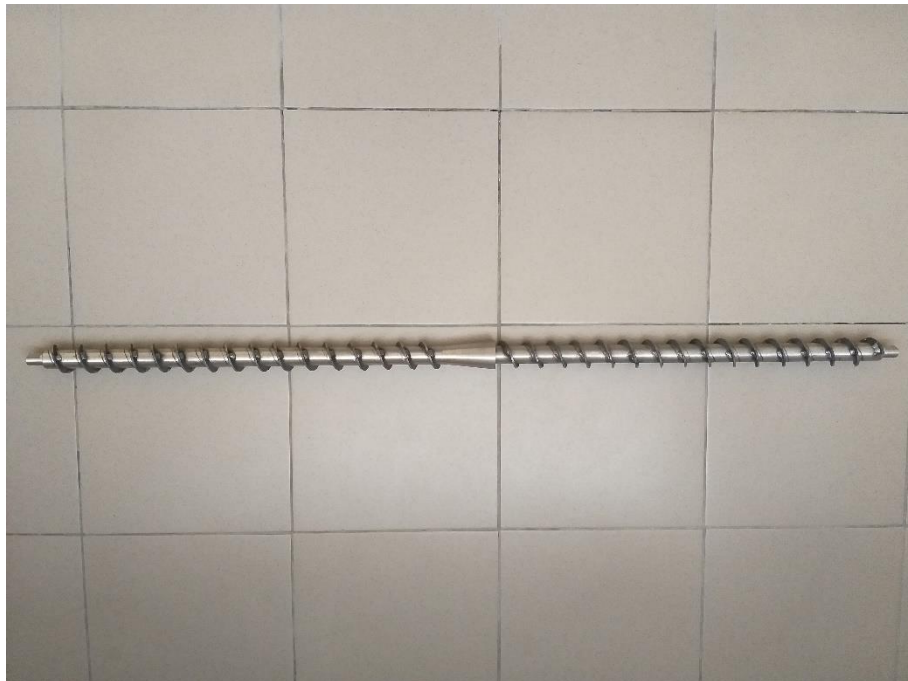
Рис. Б.14. Шнек макетного зразку шнекового електромеханічного гідролізера
