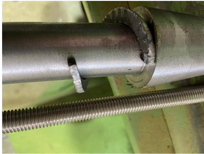
Рис. Б.13. Зварювання валу та витків шнеку макетного зразку шнекового електромеханічного гідролізера
