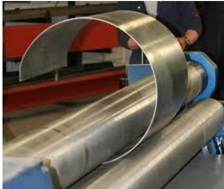
Рисунок 1.6 – формування циліндричної деталі прокаткою металевго листа між валками
