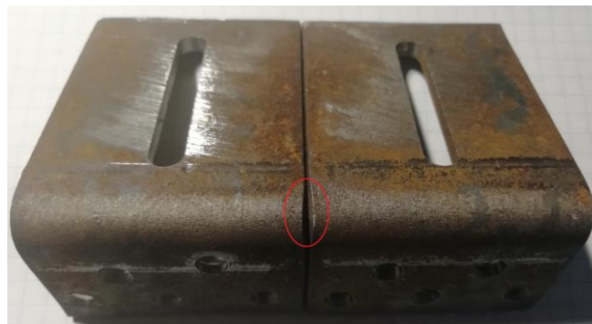
Рисунок 1.4 – Дві однаково зігнуті пластини, на яких видно зменшення ширини зовнішньої поверхні циліндричної частини
