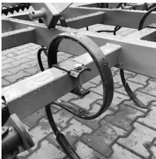
Рисунок 3.10 – Стояк лапи S-подібної форми на рамі культиватора
