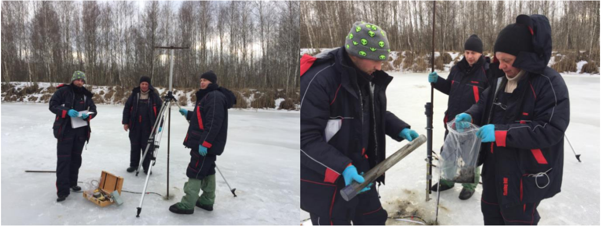
Рис. 2.4. Проведення вимірювань вертикальних профілів потужності доз гамма-випромінення та відбір проб донних відкладень
