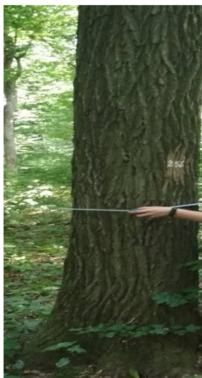
Рис. 2.7. Вимірювання діаметру дерев із застосуванням мірної вилки Codimex на висоті 1,3 м із точністю до 0,1 см
