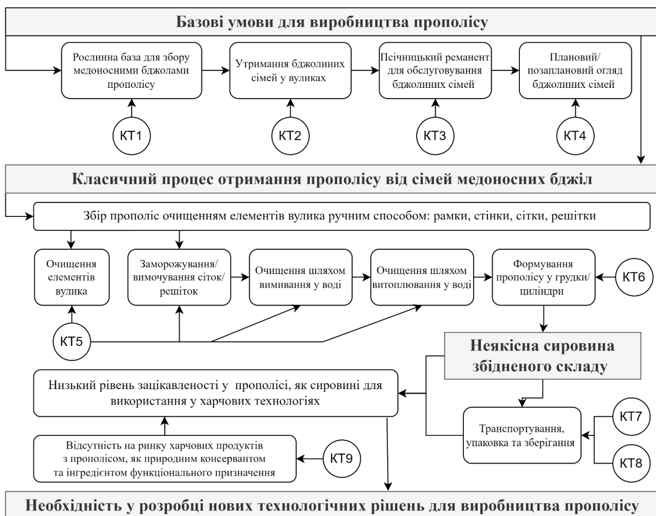
Рис. 4.1. Принципова схема класичної технології отримання прополісу
