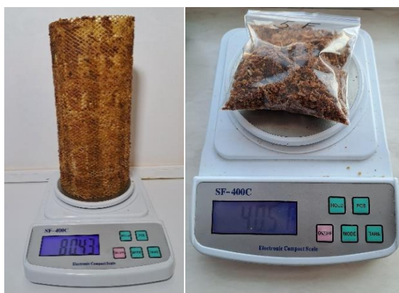
Рис. 2.6. Зображення процесу зважування сіток покритих прополісом та зразків прополісу із використанням електронних ваг SF-400C
