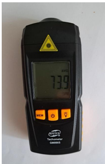
Рис. 2.4. Зображення електронного лазерного тахометра ТМ Benetech з фіксацією показника обертів валів пристрою у холостому ході
