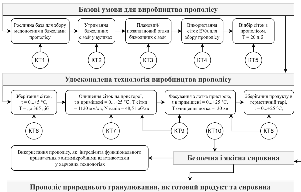
Рис. 4.2. Принципова схема удосконаленої технології виробництва прополісу
