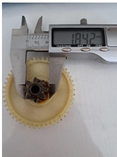
Рис. 2.7. Зображення процесу вимірювання розмірів зубчатого колеса редуктора пристрою з використанням штангенциркуля
