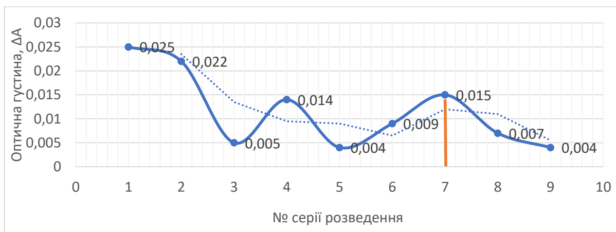
Рис. 3.5 Оптична густина комплексів НЧ \text{Cu} з карбамідом, довжина хвилі 585 нм.
