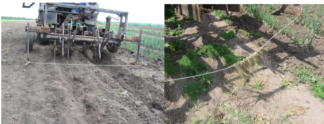
Рисунок 1 – Загальний вид установки для поверхневого обробітку ґрунту з тросом
