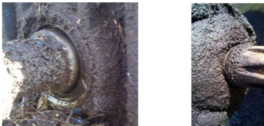
Рисунок 2 – Зовнішній вигляд агрегатів сільськогосподарської техніки при порушенні герметичності ущільнень підшипникових вузлів
