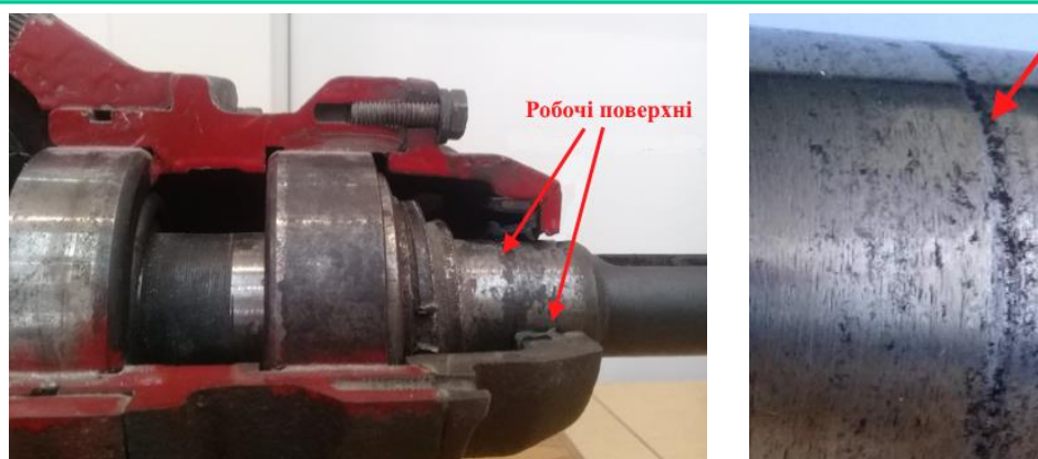
Рисунок 6 – Корозія робочої поверхні валу у зоні контакту з манжетою
