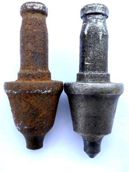
Рисунок 3 – Різці дорожньої фрези: а – зношений, б – новий
