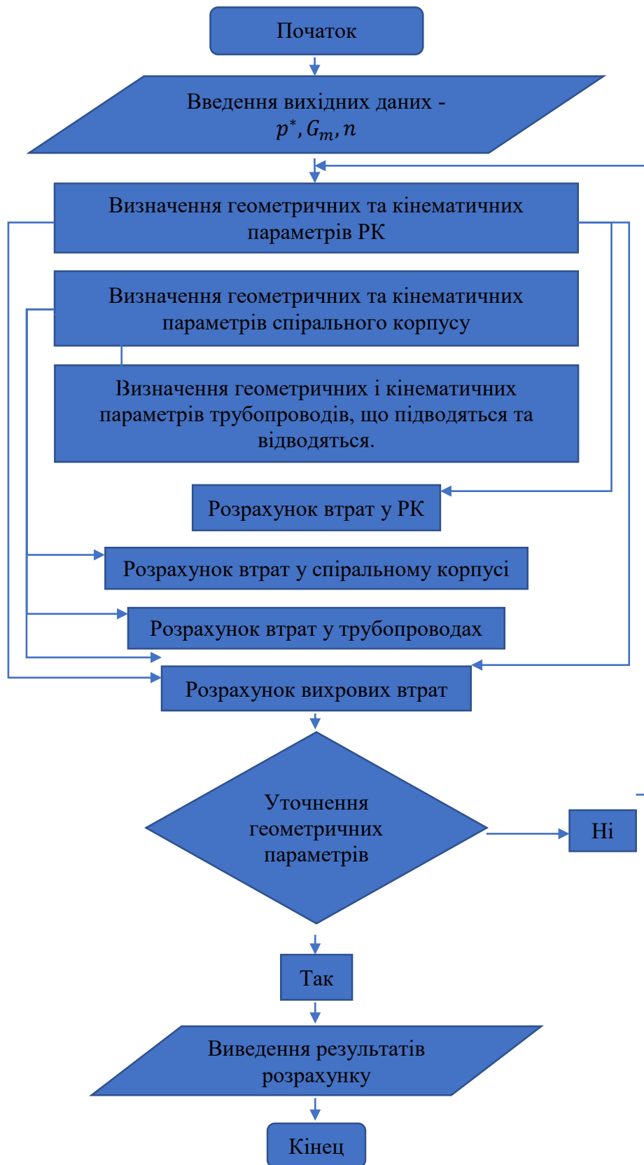
Рисунок 1 – Блок – схема алгоритму розрахунку параметрів проточної частини ВРВ.
