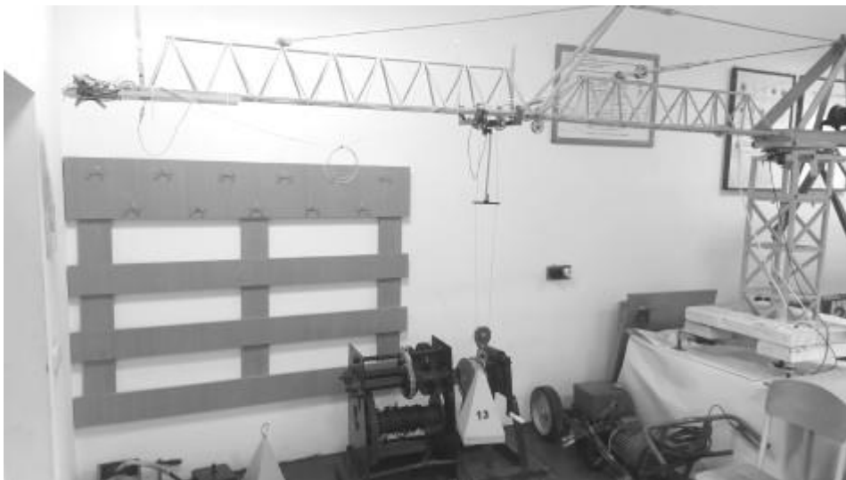
Рис. 1. Лабораторна установка баштового крана з навішеним вантажем
