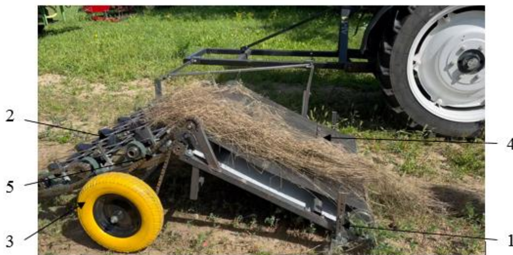
Рис.1. Засіб приготування трести: 1 - підбирач; 2 - розпушувач; 3 - опорно - ходові колеса; 4 - тягова стрічка із зубовими планками; 5 - ланцюгова передача
