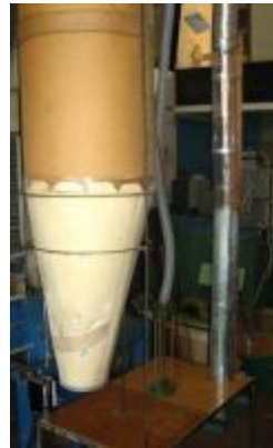
Рис. 1. Принципова схема та загальний вигляд парусного класифікатора.
