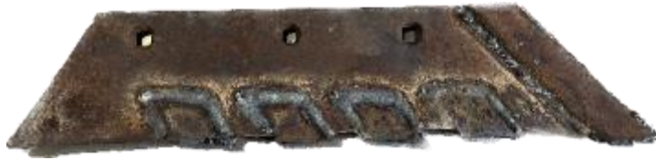
Рисунок 2 – Плужний леміш з постановкою компенсуючих вставок
