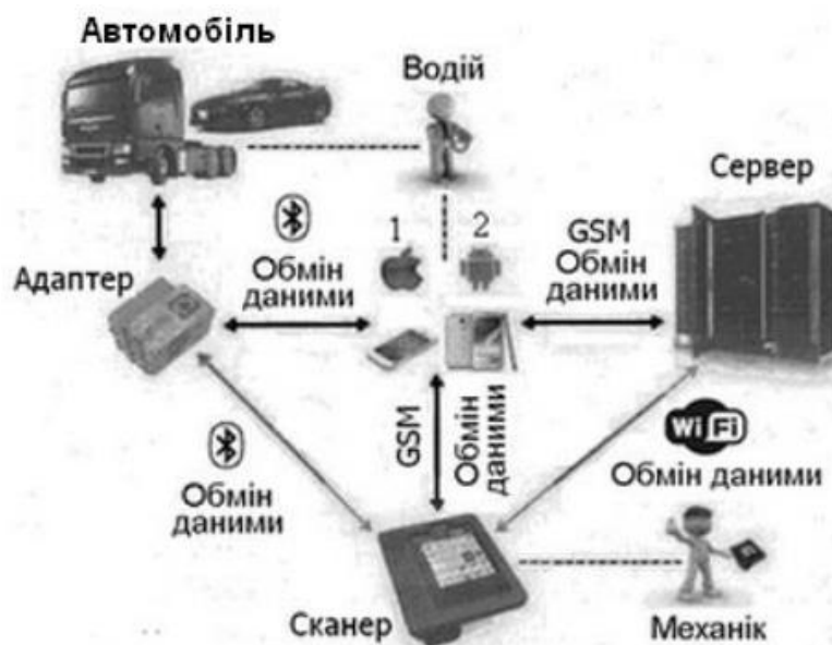
Рисунок 1 – Схема дистанційної комп'ютерної діагностики автомобіля 1–смартфон (на операційній системі IOS); 2–планшет (на операційній системі Android); – блютус передача даних
