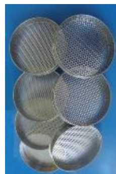
Рис. 2. Вібраційно-решітний класифікатор РКФ-1: а – функціональна схема; б – набір решіт.
