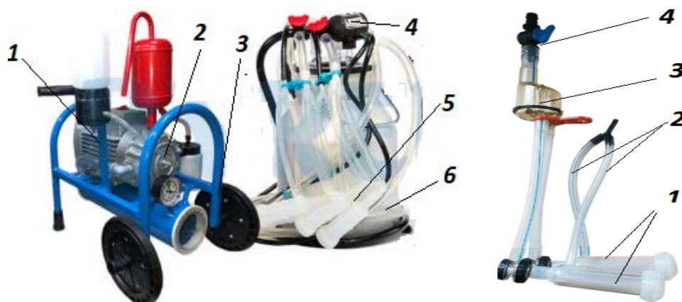
Рис.1 Загальний вид доїльної машини (а) та підвісної частини доїльного апарату (б): а – 1 – електродвигун; 2 – вакуумний насос; 3 – рама вакуумної установки; 4 – пульсатор; 5 – підвісна частина доїльного апарату; 6 – молочний бідон; б – 1 – доїльні стакани; 2 - трубки керування; 3 – збірна камера; 4 – кран.
