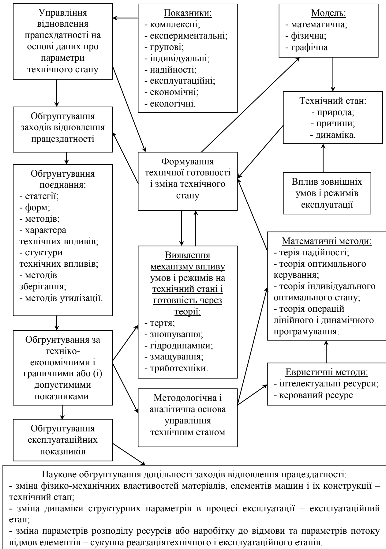
Рис. 1. Структура зв'язків, що забезпечують технічну готовність і справний стан сільськогосподарських машин.
