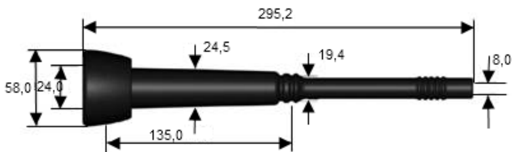
Рис. 1. Загальний вид дійкової гуми (номер гуми DeLaval 960000-01).
