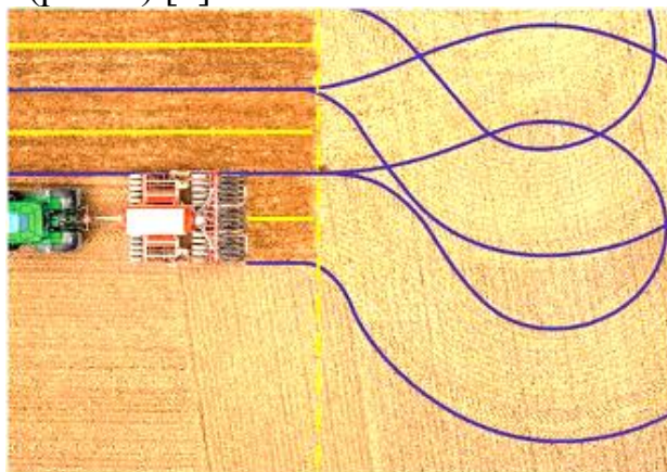
Рис. 2. Траєкторія розвороту агрегату за допомогою AutoTrac [1].
