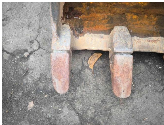
Рис. 3. Корозійні процеси на поверхні елемента A_1 .
