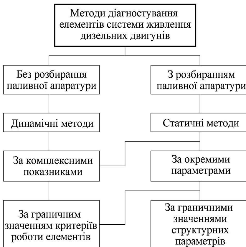
Рис. 1. Класифікація методів діагностування прецизійних елементів паливної системи дизельних двигунів/
