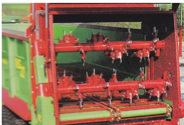
Рис. 1. Барабанний шнековий розкидний робочий орган з горизонтальною віссю обертання.
