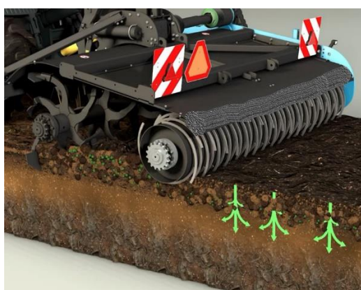
Рис. 2. Моделювання робочого процесу ротаційного лопаті в ґрунті.
