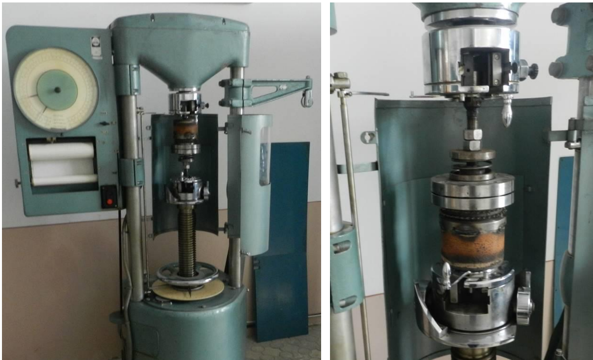
Рис. 1. Загальний вигляд машини КМ–50–1, на якій встановлена запобіжна муфта
