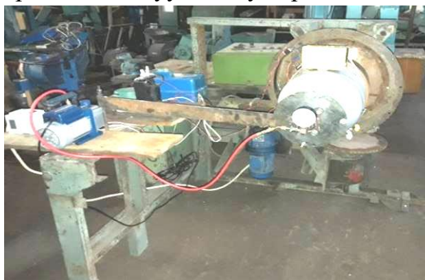
Рис. 1 Загальний вигляд фізичної моделі експериментальної барабанної вакуумної сушарки насіння.
