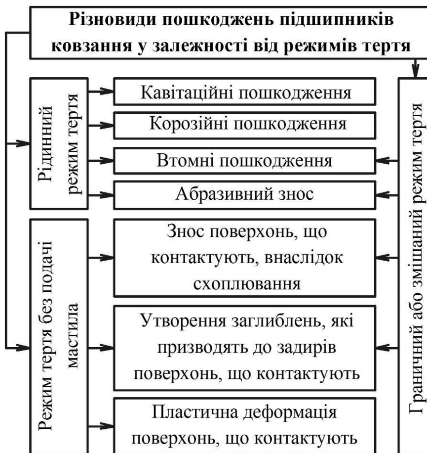
Рис. 1. Різновиди пошкоджень підшипників ковзання
