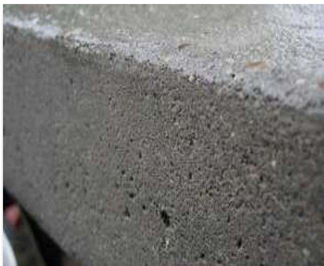
Рис. 1. Блок з полімерцементного бетону
