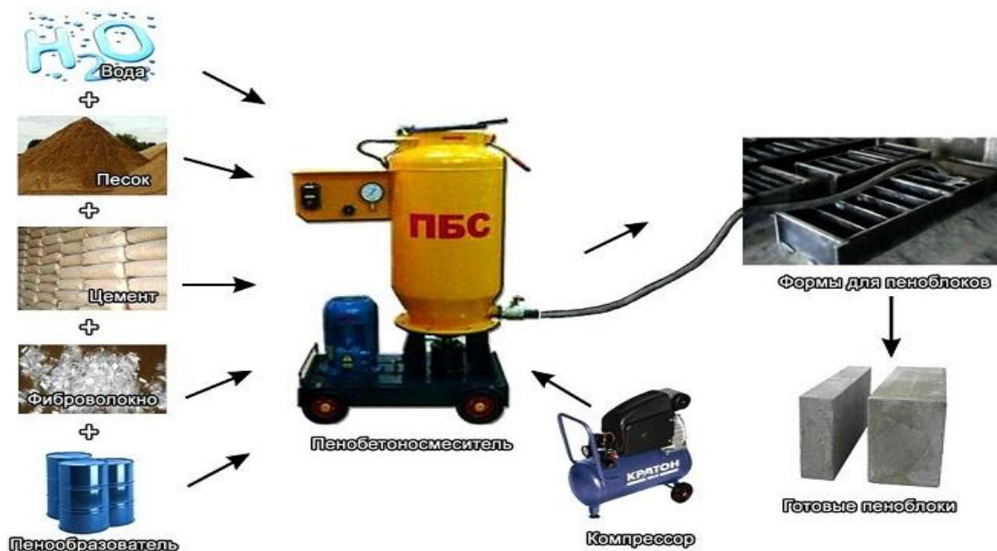
Рис. 2. Класична технологія виготовлення пінобетону
