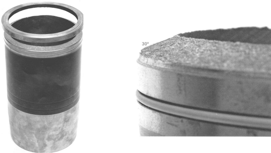
Рис. 2. Надлом бурту гільзи циліндра. Злам з грубою структурою і кутом приблизно 30 градусів
