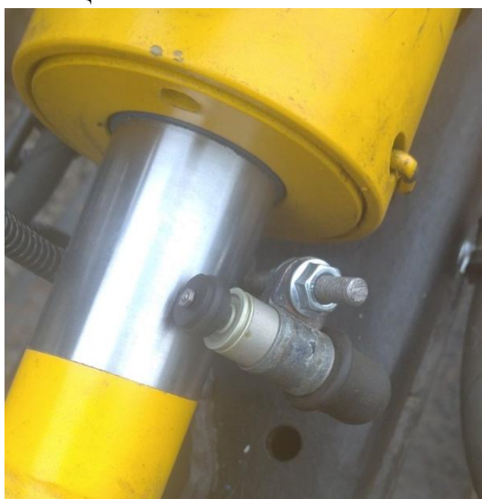
а) б) Рис. 4 Розміщення датчиків лінійного переміщення: а) датчик лінійного переміщення штоку гідравлічного циліндра приводу рукояті; б) датчик лінійного переміщення телескопічної секції
