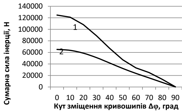
Рис. 2. Графіки зміни максимальних F_{ic\max} (1) та середньоквадратичних \bar{F}_{ic} (2) значень сил інерції в залежності від кута зміщення кривошипів \Delta\varphi
