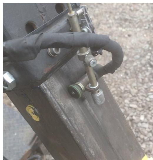
а) б) Рис. 4 Розміщення датчиків лінійного переміщення: а) датчик лінійного переміщення штоку гідравлічного циліндра приводу рукояті; б) датчик лінійного переміщення телескопічної секції
