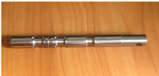
в) г) Рис. 3. Гідравлічний золотник: а) штатний конструктивно не змінний золотник; б) характеристика зміни прохідної площі робочого каналу від переміщення золотника; в) конструктивно змінний золотник; г) характеристика зміни прохідної площі робочого каналу від переміщення золотника
