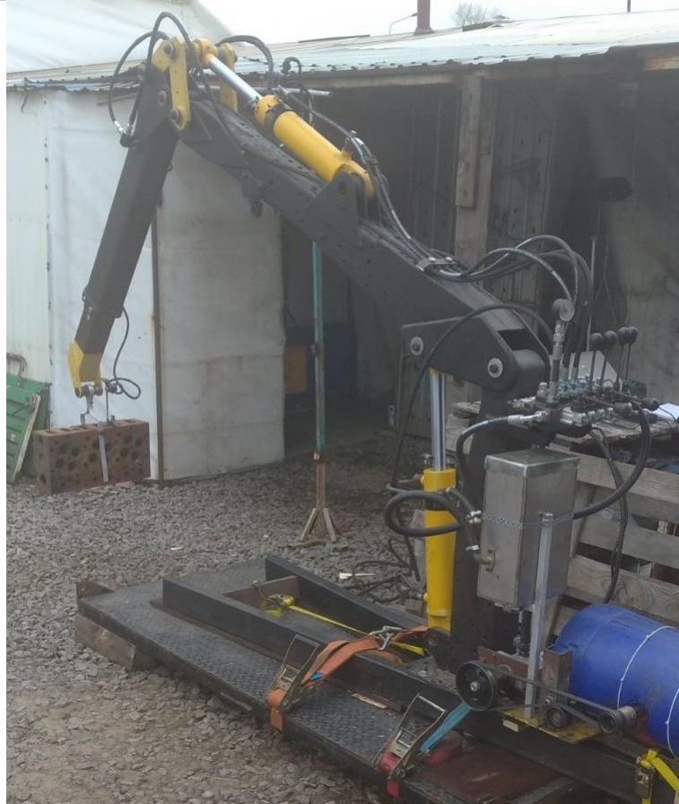
Рис. 1. Експериментальна установка крана-маніпулятора з гідролічним приводом
