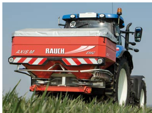
Рис. 2. Розкидач добрив Rauch з електроприводом.
