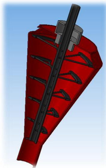
Рис. 3 Бункер-накопичувач з активатором (розріз)
