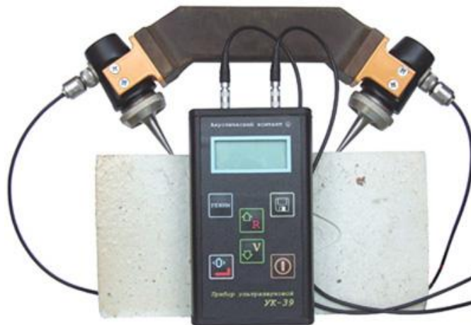
Рис. 4. Ультразвуковий метод вимірювання міцності бетону
