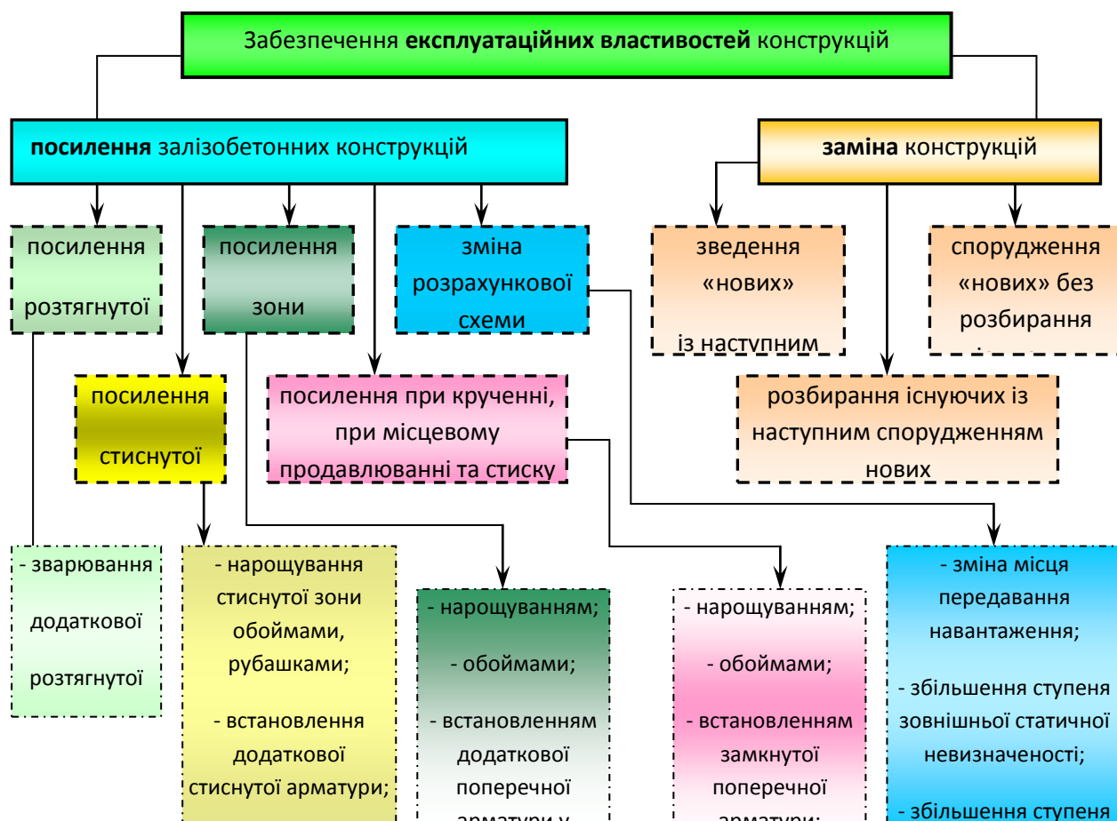
Рис. 1. Схема класифікації методів посилення залізобетонних конструкцій
