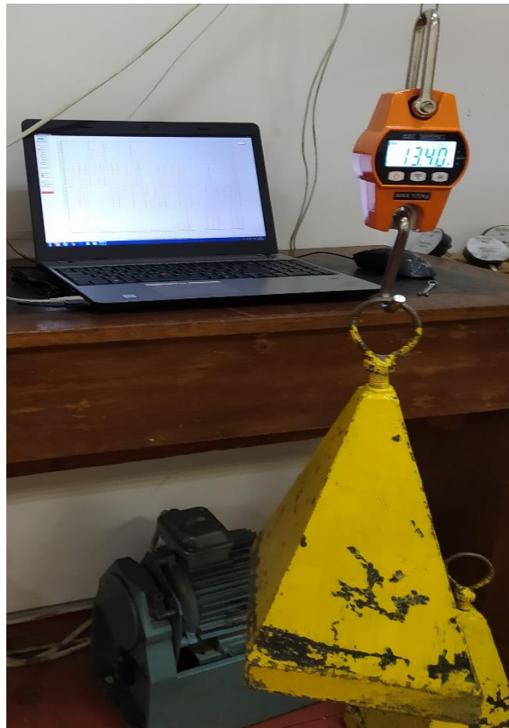
Рис. 2. Тарування S-подібного тензOMETричного давача
