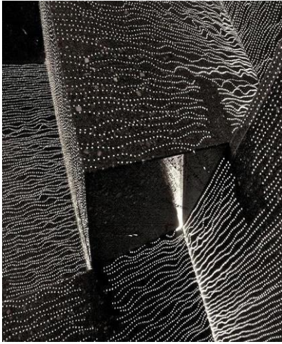
Рис. 3. Структура прозорого бетону та приклади елементів
