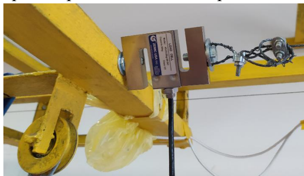
Рис. 1. Зображення закріплення S-подібного тензOMETричного давача
