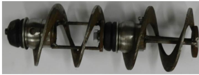
Рис. 1. Конструктивна схема (а) та загальний вигляд (б) гвинтового секційного робочого органу:
