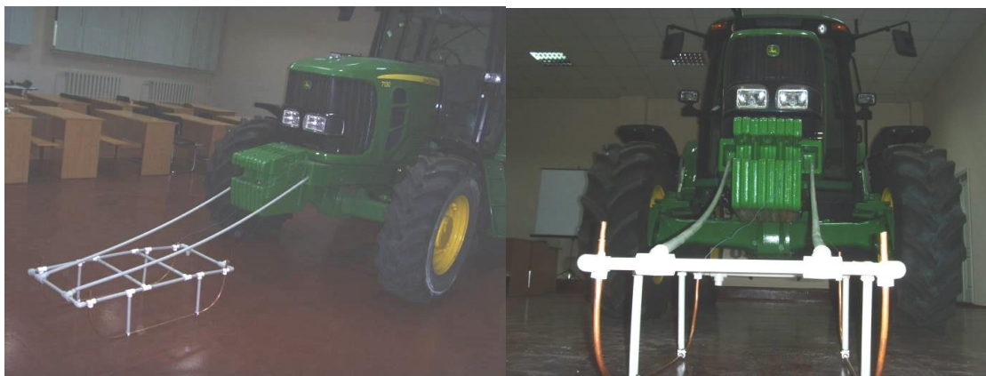
Рис. 2. Загальний вигляд пристрою для моніторингу варіабельності стану ґрунтового середовища на транспортному засобі.
