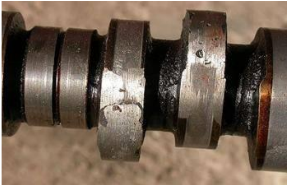
Рис. 1. Зношений газорозподільчий вал.
