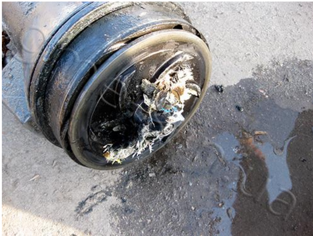
Рис. 2. Пошкодження подрібнювача насоса.
