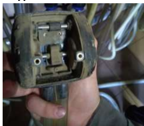
Потрапляння пилу та бруду до пульсаторів
