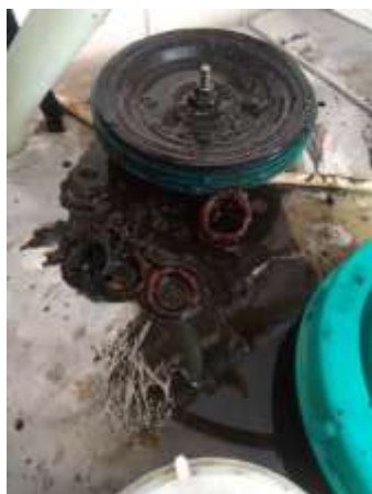
Вихід з ладу клапана подачі води
