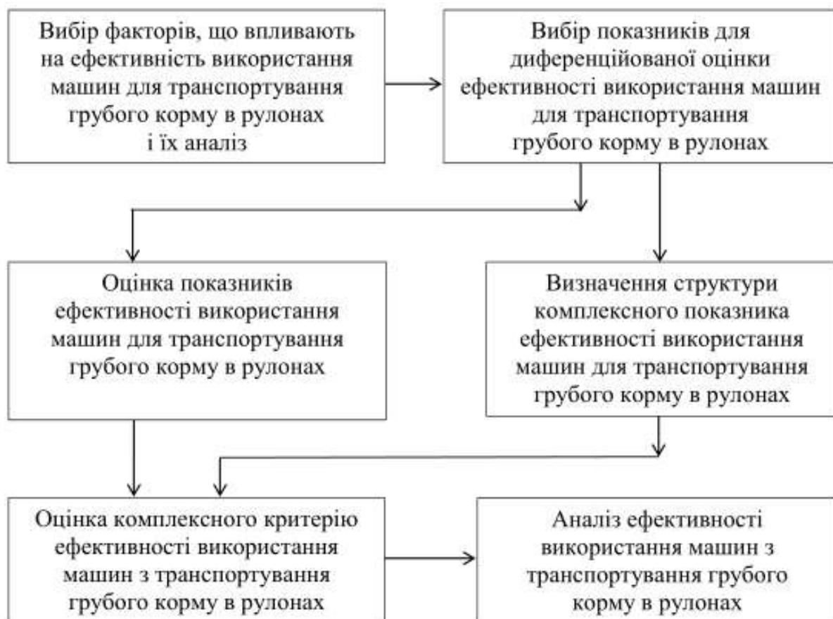
Рисунок 1. Алгоритм оцінки ефективності використання машин для транспортування грубого корму в рулонах
