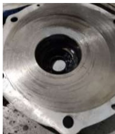
Зношені поверхні тертя вакуумного насоса
