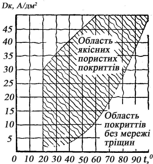
Рис. 5 Залежність якості покриттів при залізненні від щільності струму і температури електроліту
