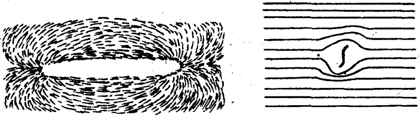
Рис. 1 Розподіл магнітного поля в границях дефекту
