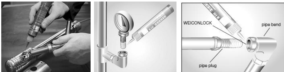
Рис. 6 Схема ущільнення трубних різьб і фланцевих з'єднань анаеробними клеями
