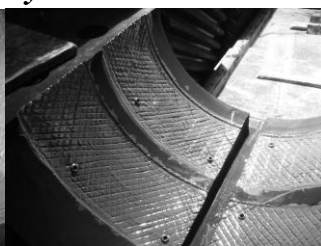
Рис. 7 Застосування анаеробних герметиків для усунення дефектів тріщин
