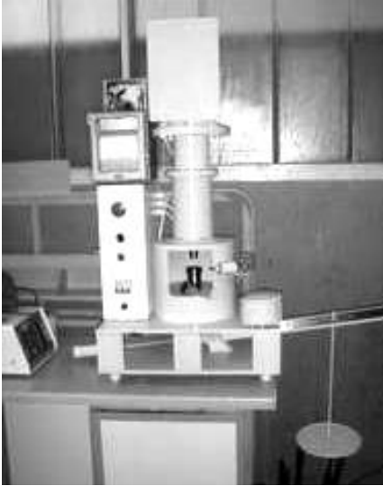
Рис. 2 Загальний вид чотирикулькової машини тертя ЧШМ «ОСА»
