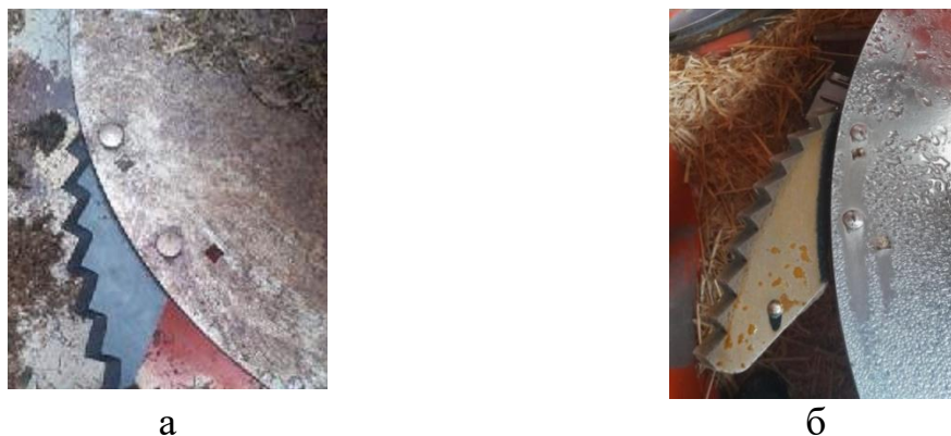
Рис. 1. Ножі змішувачів-кормороздавачів PROFILE 12.2 DS та PROFILE 14.2 DS в умовах експлуатації: а - ніж малий; б - ніж великий.
