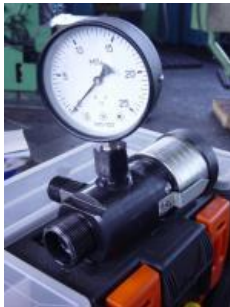
Рис. 1. Дросель-витратомір СДР-ЗУК: 1 - корпус; 2 - порожнина; 3 - затвор; 4 - манометр; 5 - шкала; 6 - вхідний штуцер; 7 - вихідний штуцер; 8 - рукоятка; 9 - вхідний канал.
